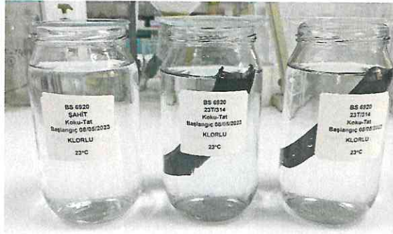
Şekil 2. 23T/314 no'lu "Yüksek Yoğunluklu Polietilen Boru" örneği(23°C)
