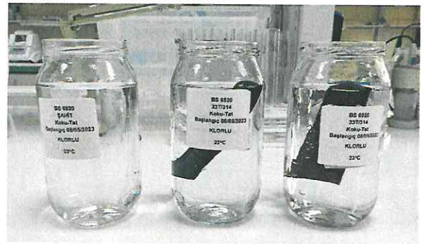
Şekil 2. 23T/314 no'lu "Yüksek Yoğunluklu Polietilen Boru" örneği(23°C)
